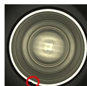
USZKODZENIE KOŁNIERZA
